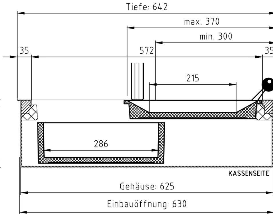
DIE SCHIEBEMULDE WIRD VON OBEN IN DEN VORBEREITETEN AUSSCHNITT EINGESETZT ODER VON DER KASSESEITE EINGESCHOBEN.
