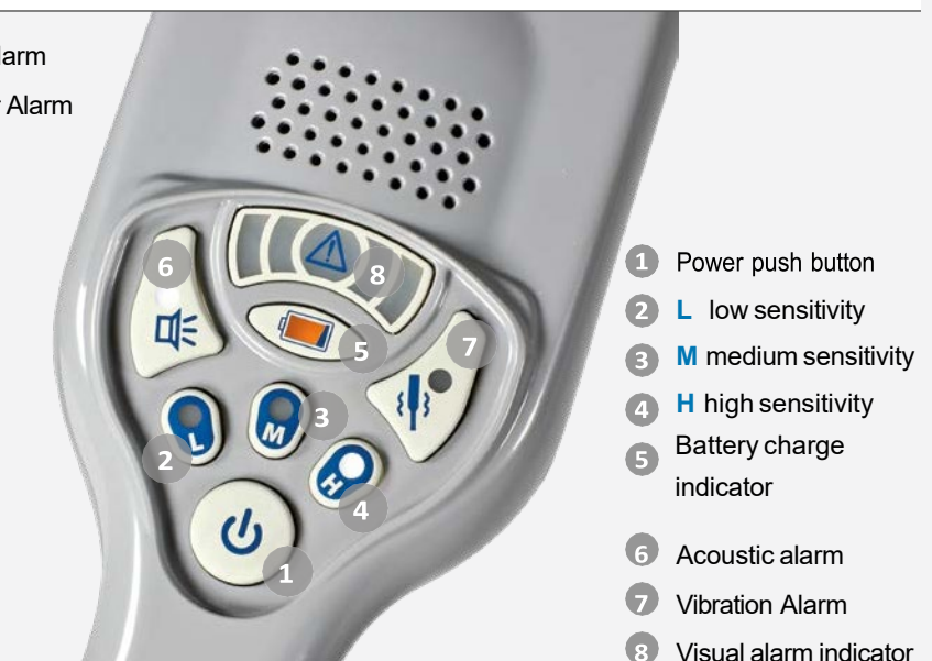
Optische Anzeige proportional zur Signalstärke (Niedrig, Mittel, Hoch)
